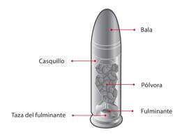
Figura 1. Diagrama de las partes del cartucho metálico
